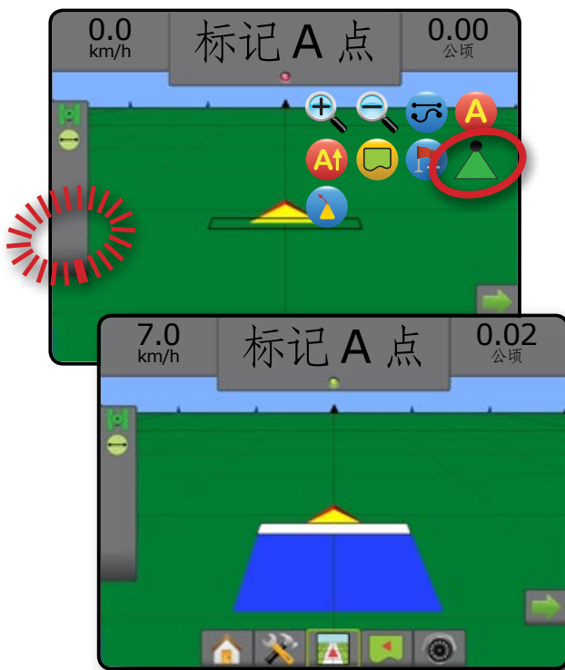
图 6-40: 所有喷杆关闭/开启 — 无 SDM
