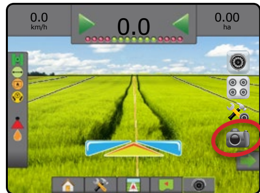
Рисунок 7-40: Просмотр в полноэкранном видеорежиме изображения с камеры режима реального видео RealView
