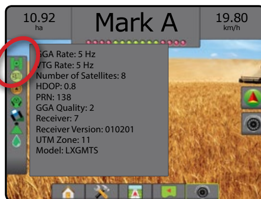
Figură 5-5: Informații de stare GNSS pe Ecranul de ghidare
