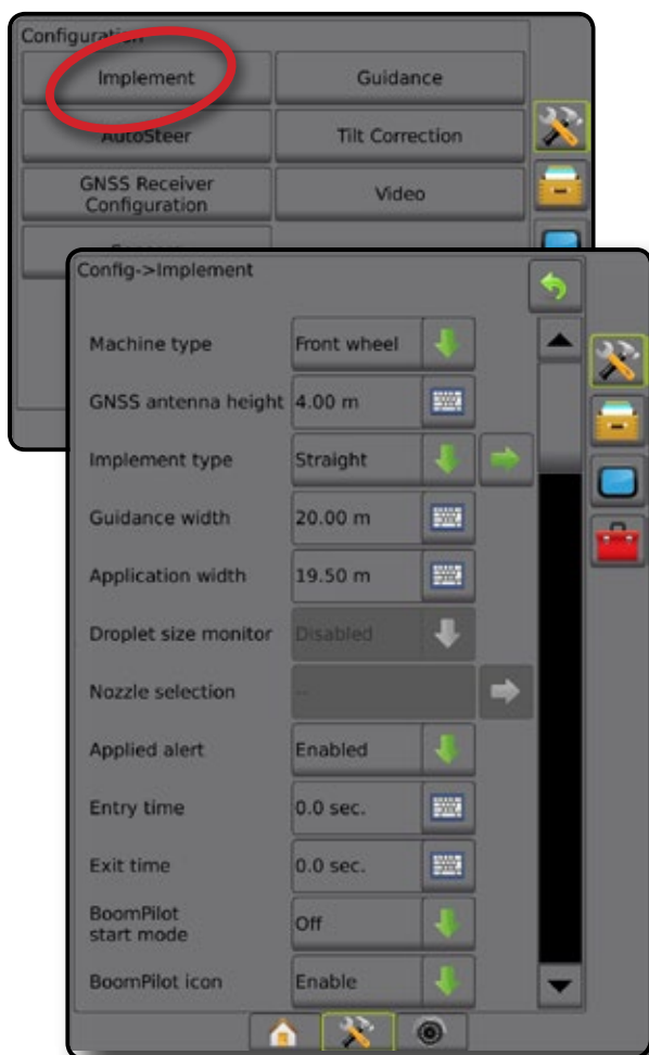
Figură 4-6: Unealtă – Configurare o singură secțiune
