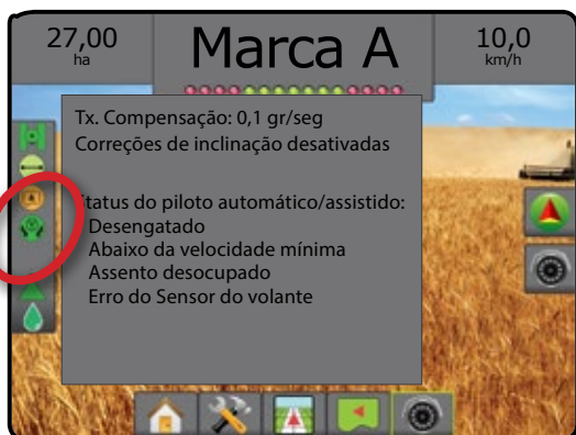
Figura 6-7: Status do piloto automático/assistido
