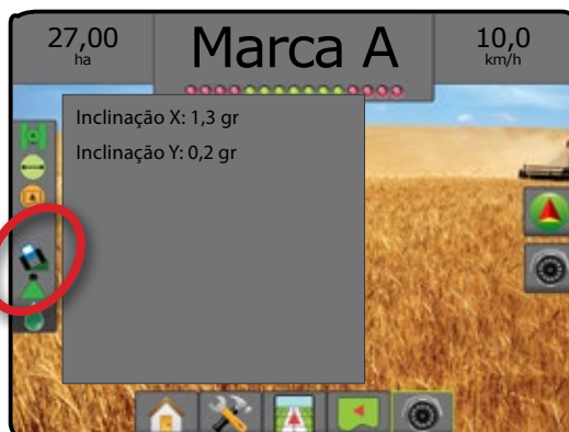
Figura 6-8: Status de correção de inclinação
