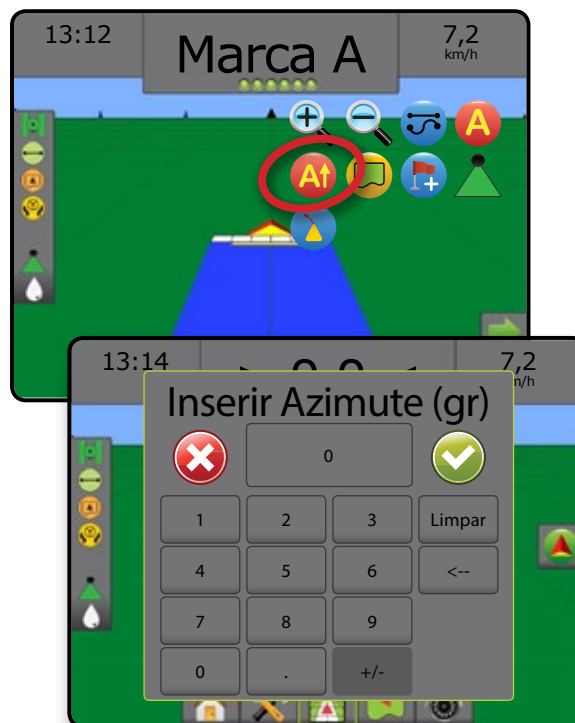
Figura 6-29: Orientação de azimute
