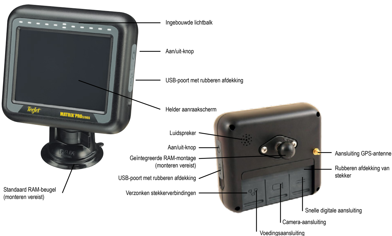
Afbeelding 1-1: Matrix Pro 570GS console voor- en achterkant
