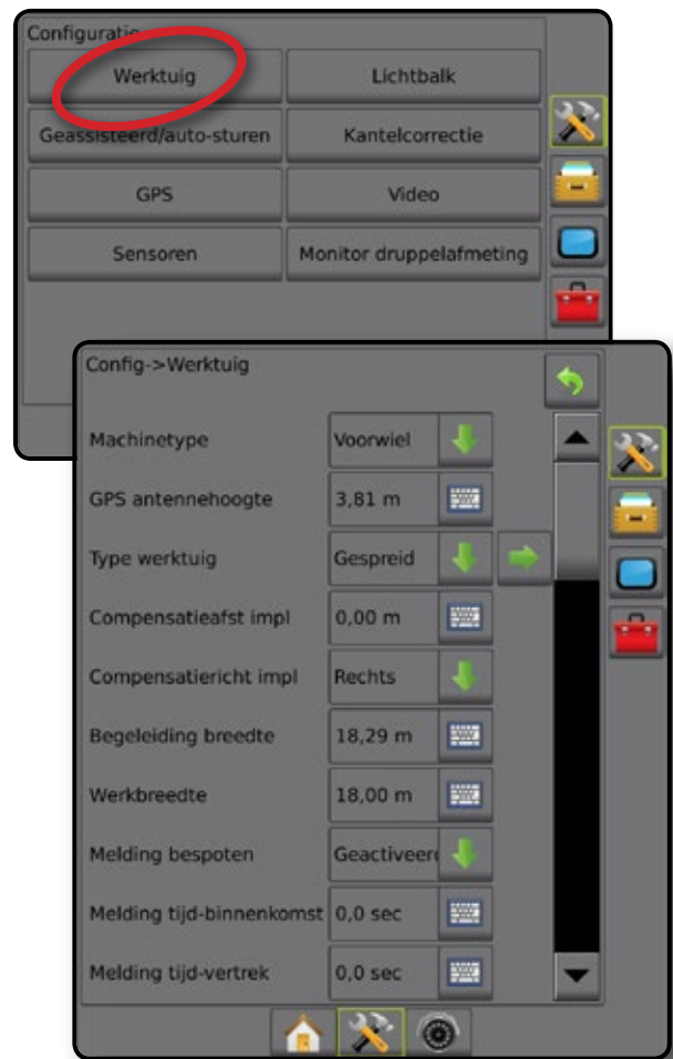
Figuur 8-8: Werktuig - Enkelvoudige sectie
