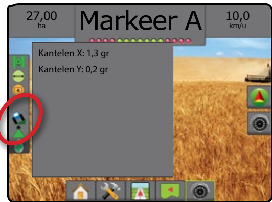
Figuur 6-8: Status kantelcorrectie
