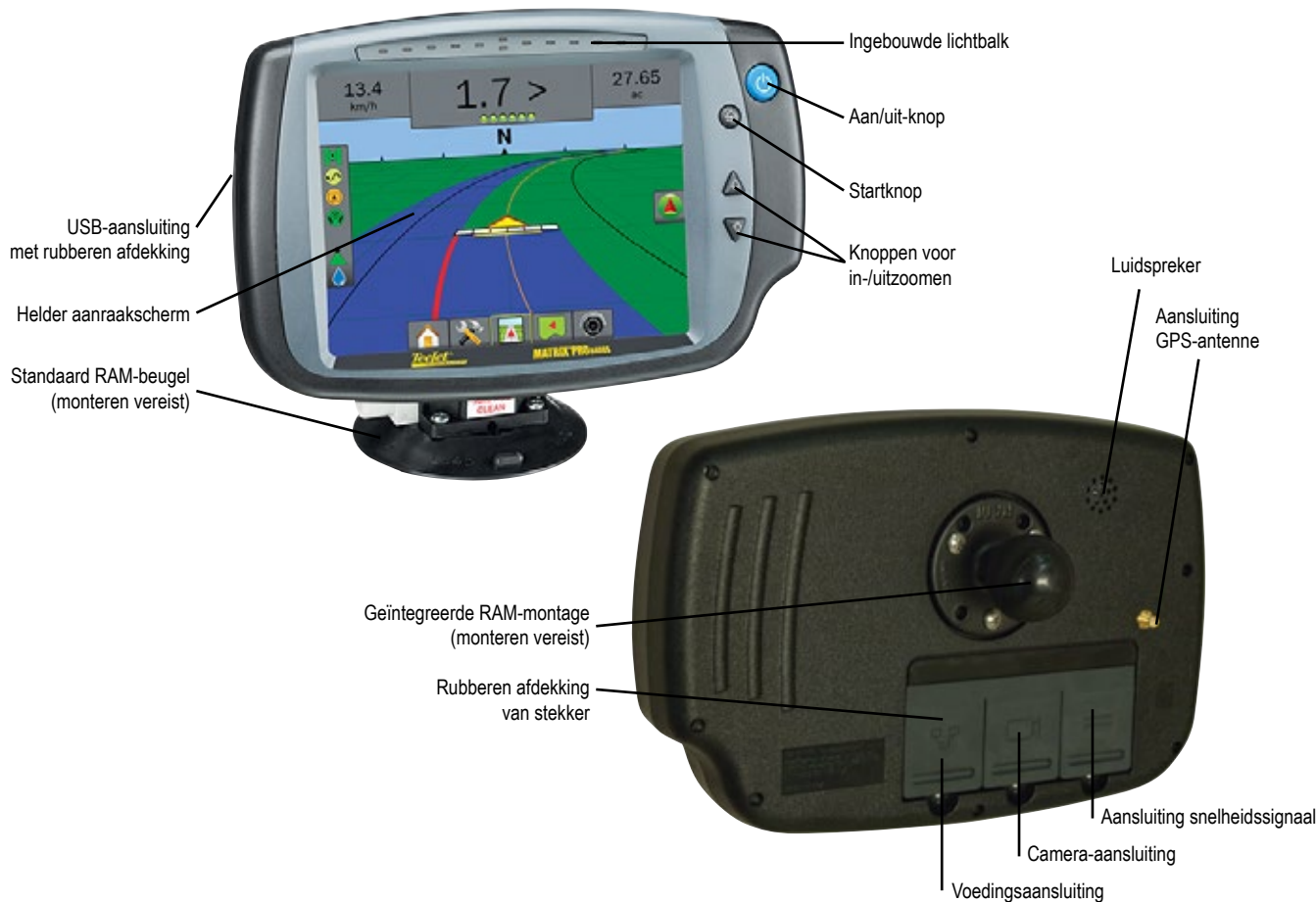
Afbeelding 1-2: Matrix Pro 840GS Console voor- en achterkant
