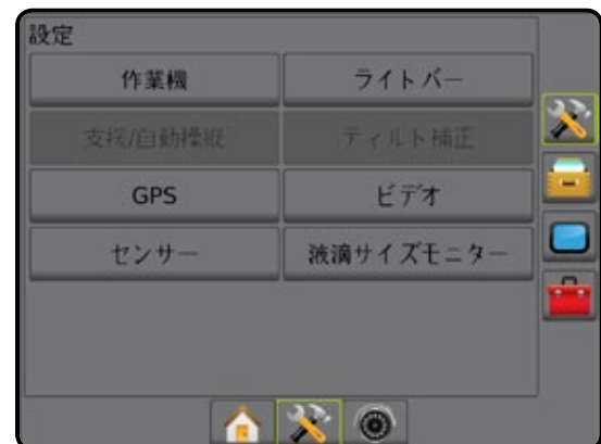
図 5-13: ティルト補正が検出されない
