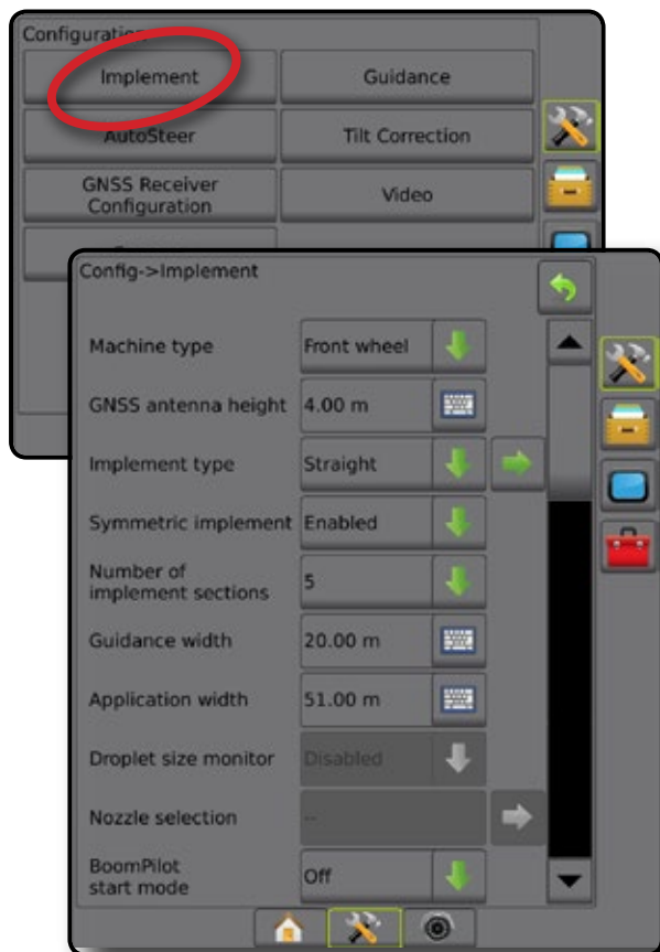
Figura 4-7: Strumento – sezioni multiple con configurazione SDM o SFM
