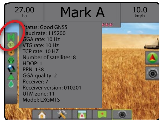
Figura 5-5: Informazioni di stato GNSS delle schermate Guida
