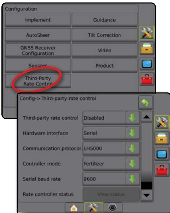
Ábra 8-2: Külső cégtől származó szórásszabályozó
