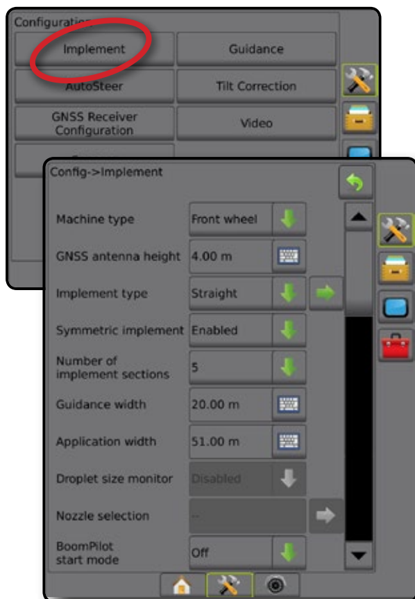
Ábra 4-7: Eszköz – többszakaszos, SDM-, illetve SFM-beállítással
