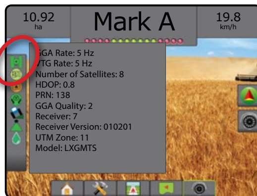
Ábra 5-5: A nyomkövetési képernyőn a GNSS állapotával kapcsolatban látható adatok
