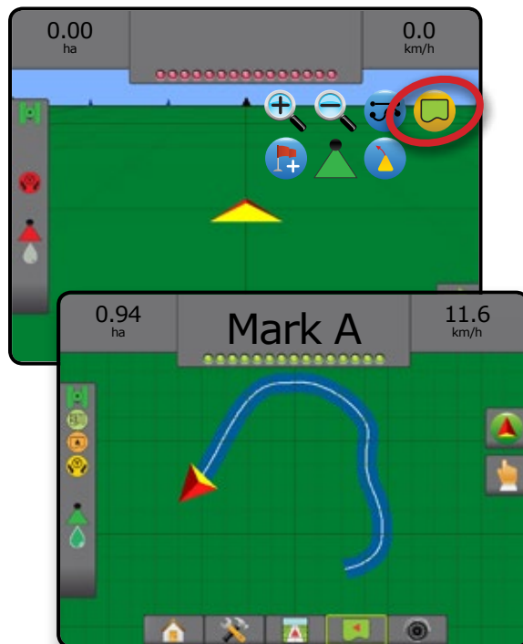
Ábra 7-22: Határvonal befejezése – egyenes vonal a kiindulási pontig
