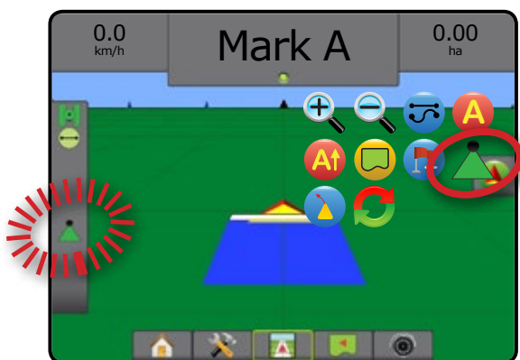
Ábra 6-38: BoomPilot-ikon a nyomkövetési képernyőn
