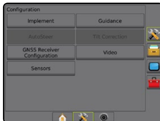
Figure 4-15 : Correction de dévers non détectée
