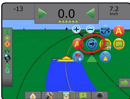
Figure 7-15 : Ligne de guidage suivante
