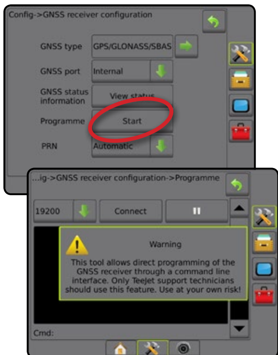
Figure 5-6 : Programmation du récepteur
