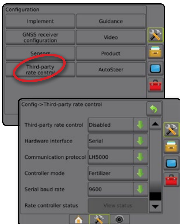
Figure 8-2 : Régulation de débit d'autres fabricants
