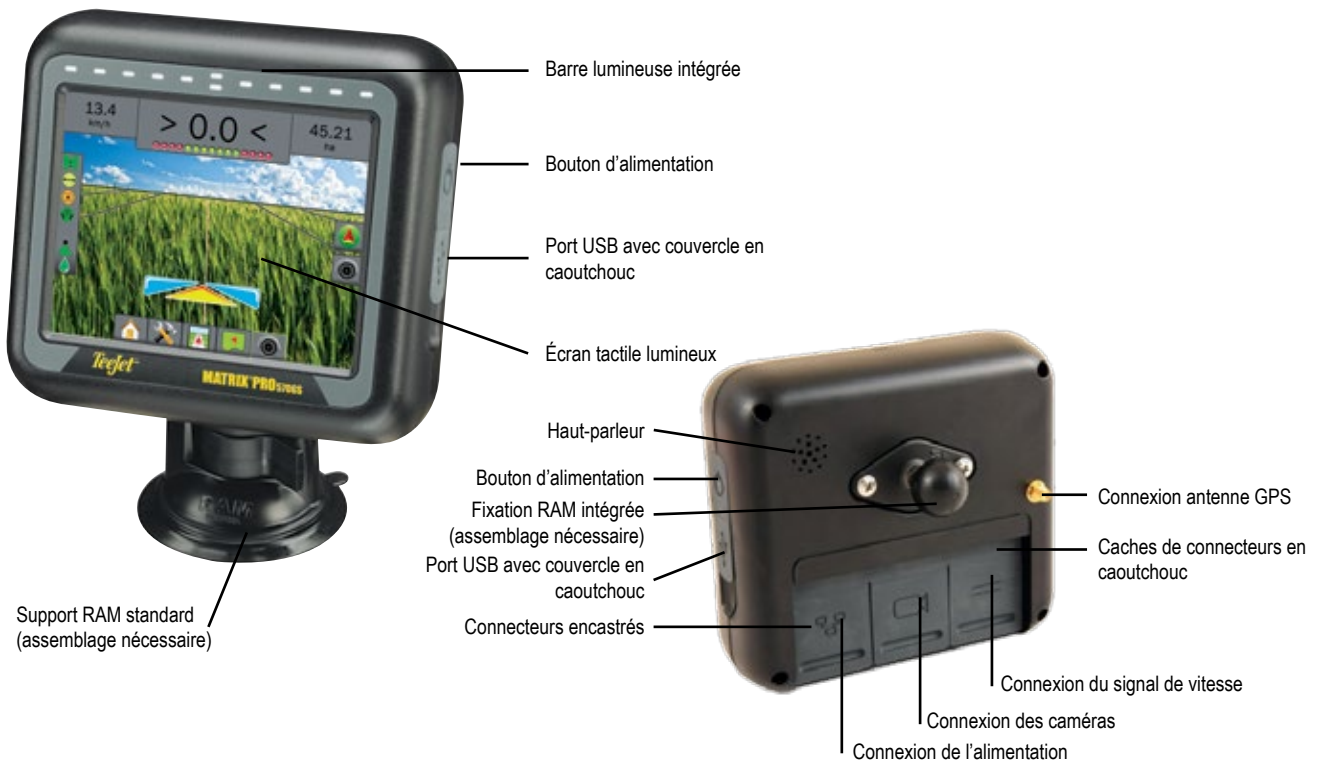
Figure 1-1 : Console Matrix Pro 570GS – Avant et arrière
