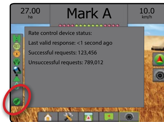
Figure 8-5 : État du régulateur de débit de bouillie
