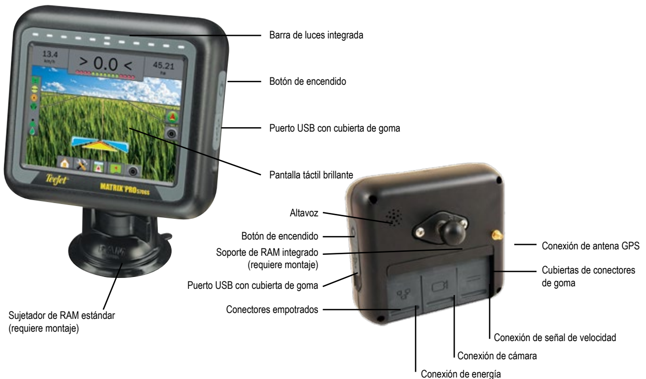
Figura 1-1: Parte anterior y parte posterior de la consola Matrix Pro 570GS
