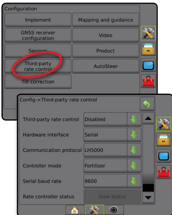
Figura 8-2: Controlador de tasas de terceros
