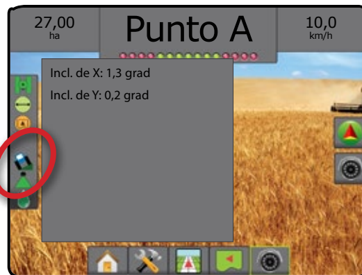
Figura 6-8: Estado de corrección de inclinación
