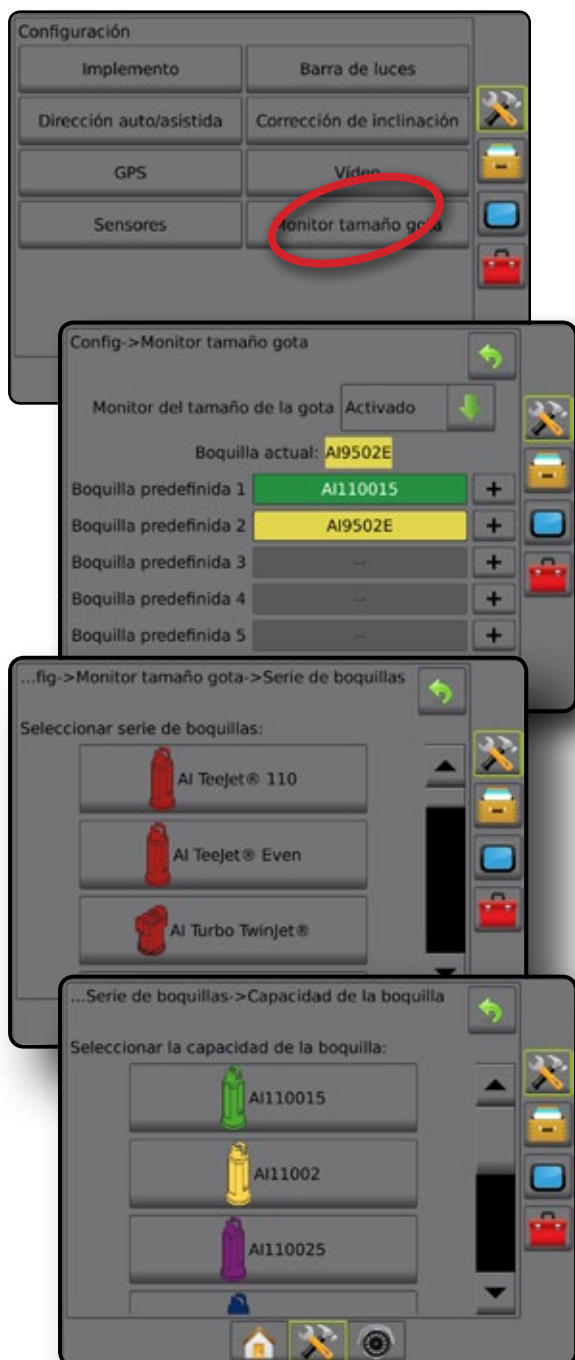
Figura 9-2: Control de tamaño de gotas y boquillas
