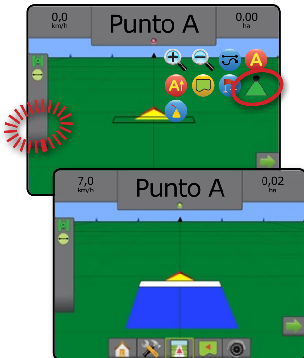
Figura 6-40: Todas las barras encendidas/apagadas: sin SDM
