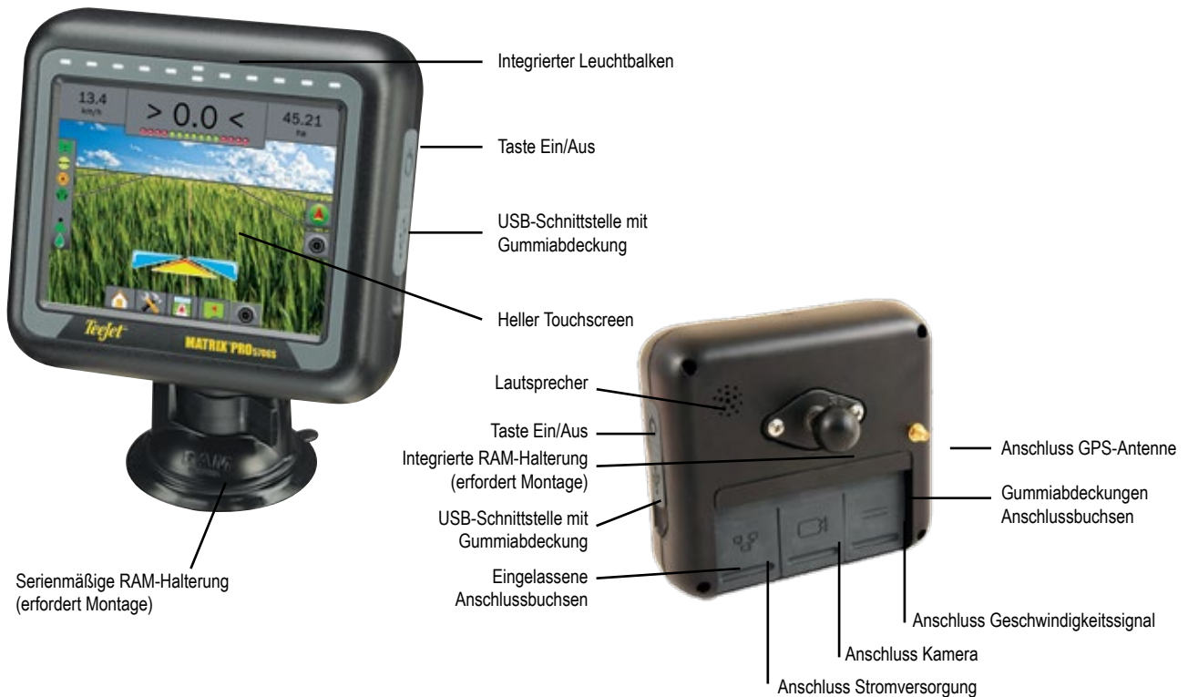
Bild 1-1: Matrix Pro 570GS Bedienkonsole, Vorder- und Rückseite
