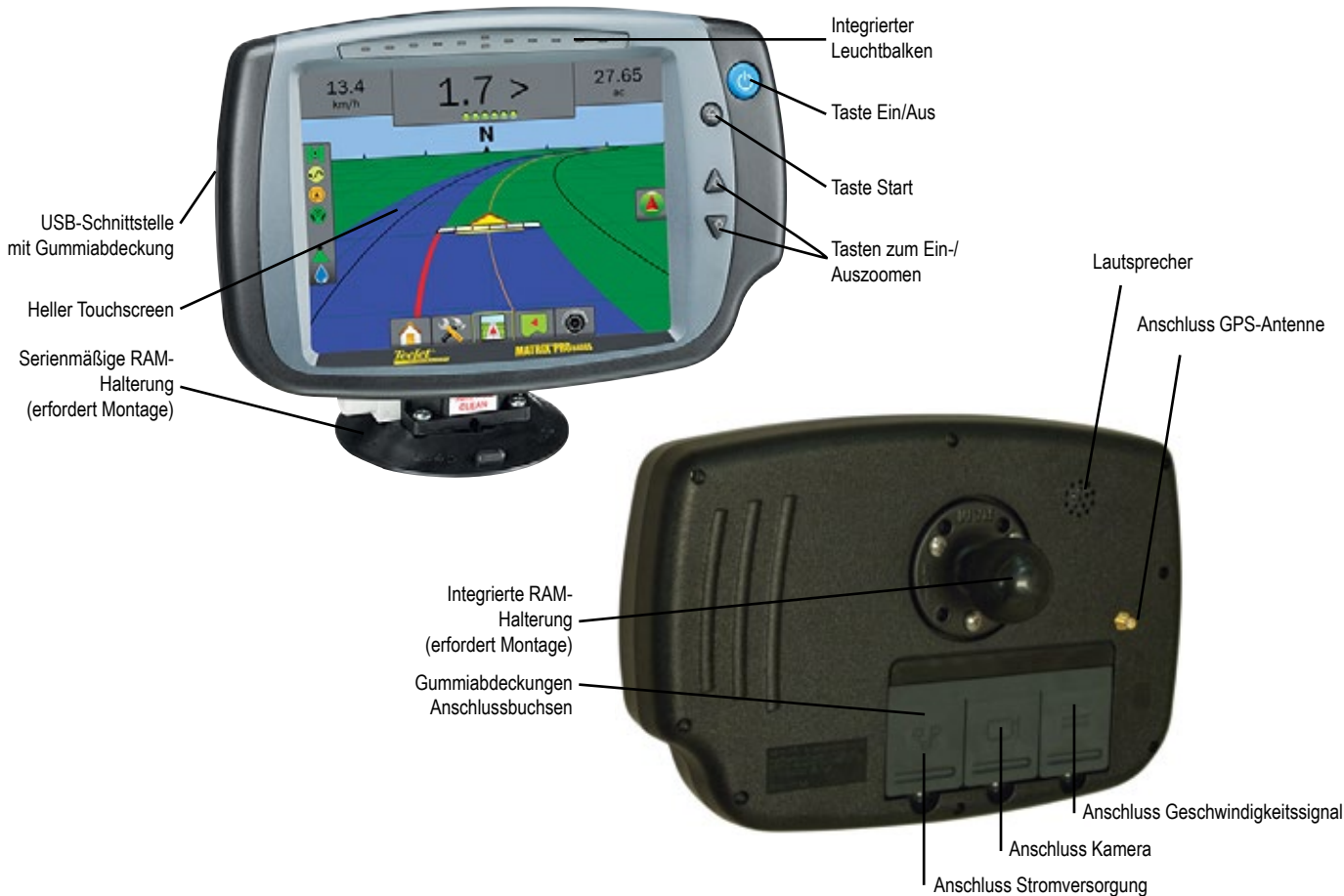
Bild 1-2: Matrix Pro 840GS Bedienkonsole, Vorder- und Rückseite
