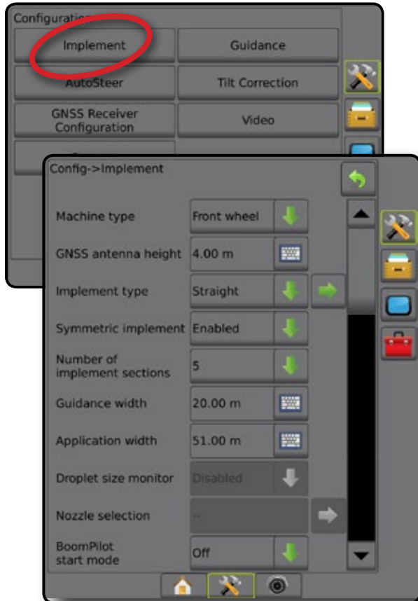
Figur 4-7: Redskab – Flere sektioner med SDM- eller SFM-opsætning
