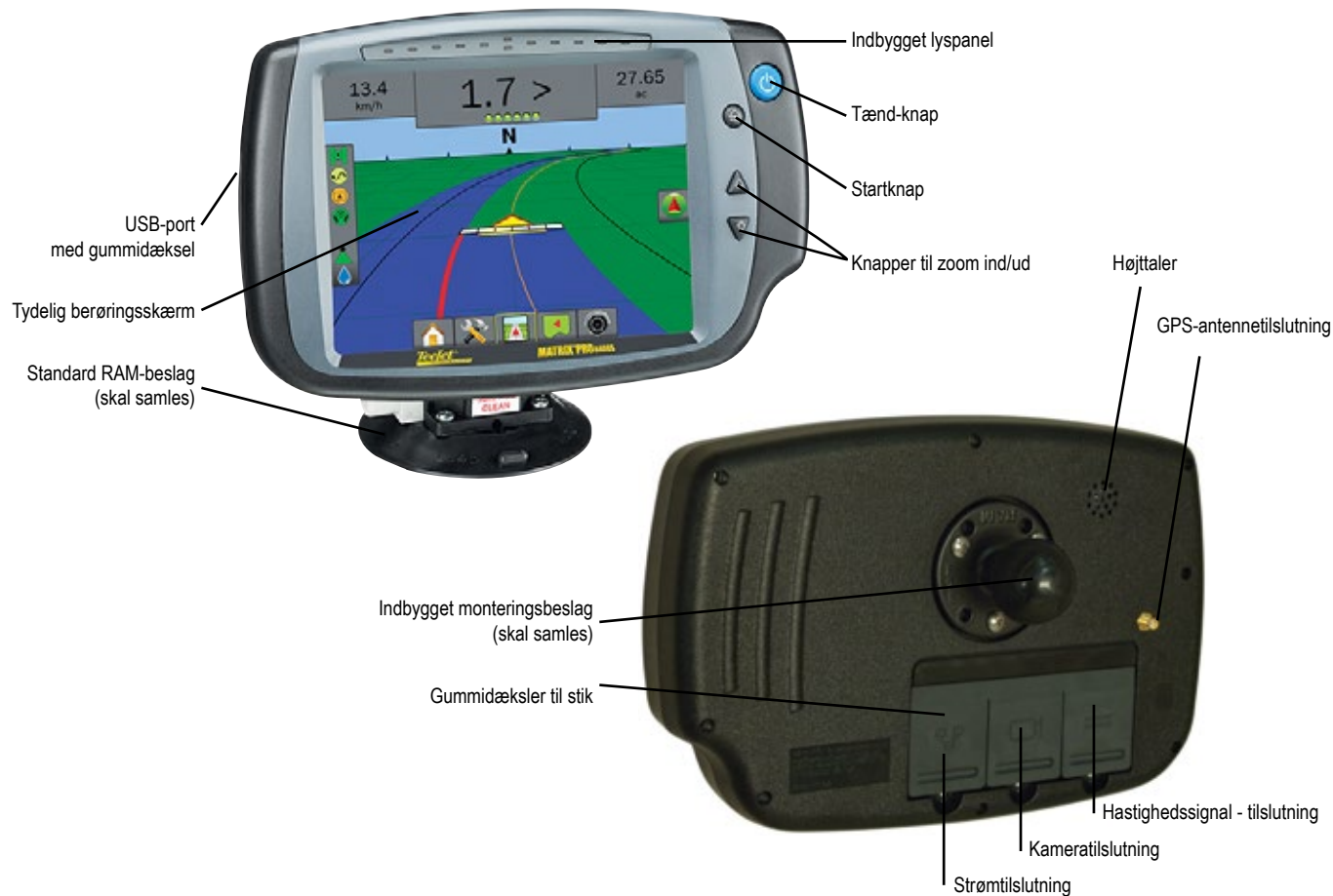
Figur 1-2: Matrix Pro 840GS-konsol – for- og bagside
