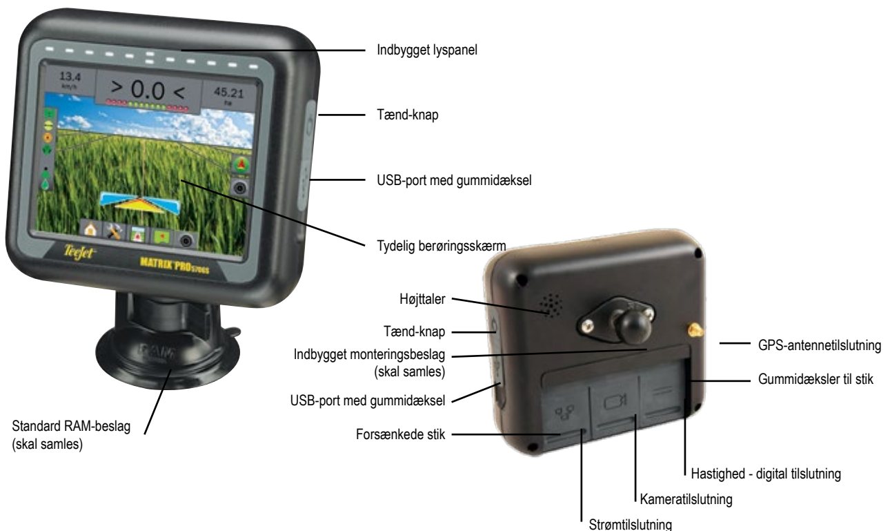
Figur 1-1: Matrix Pro 570GS-konsol – for- og bagside
