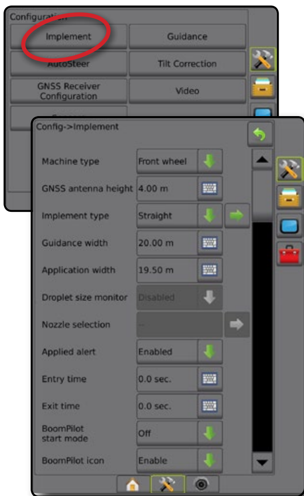
Figur 4-6: Redskab – Opsætning af enkel sektion
