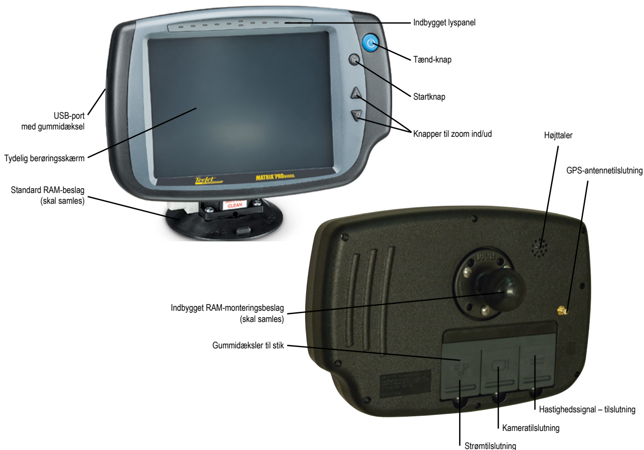
Figur 1-2: Matrix Pro 840GS-konsol – for- og bagside
