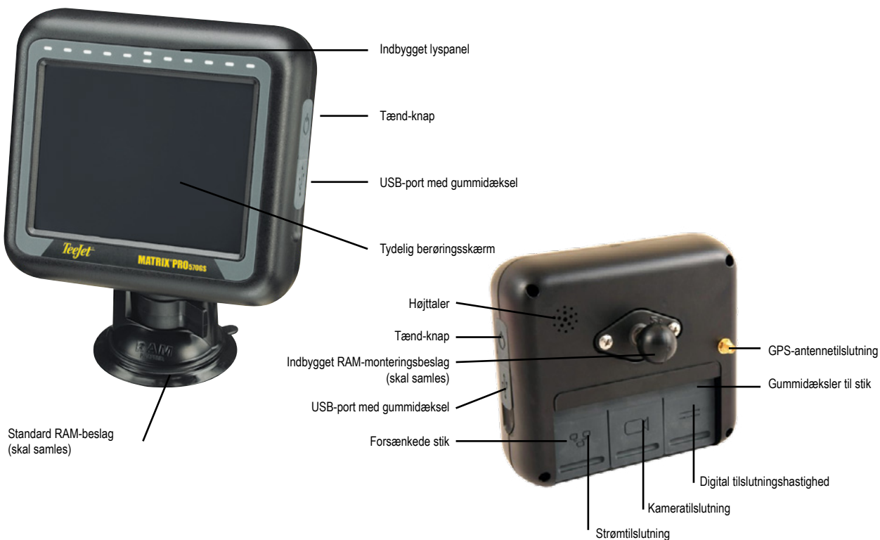
Figur 1-1: Matrix Pro 570GS-konsol – for- og bagside
