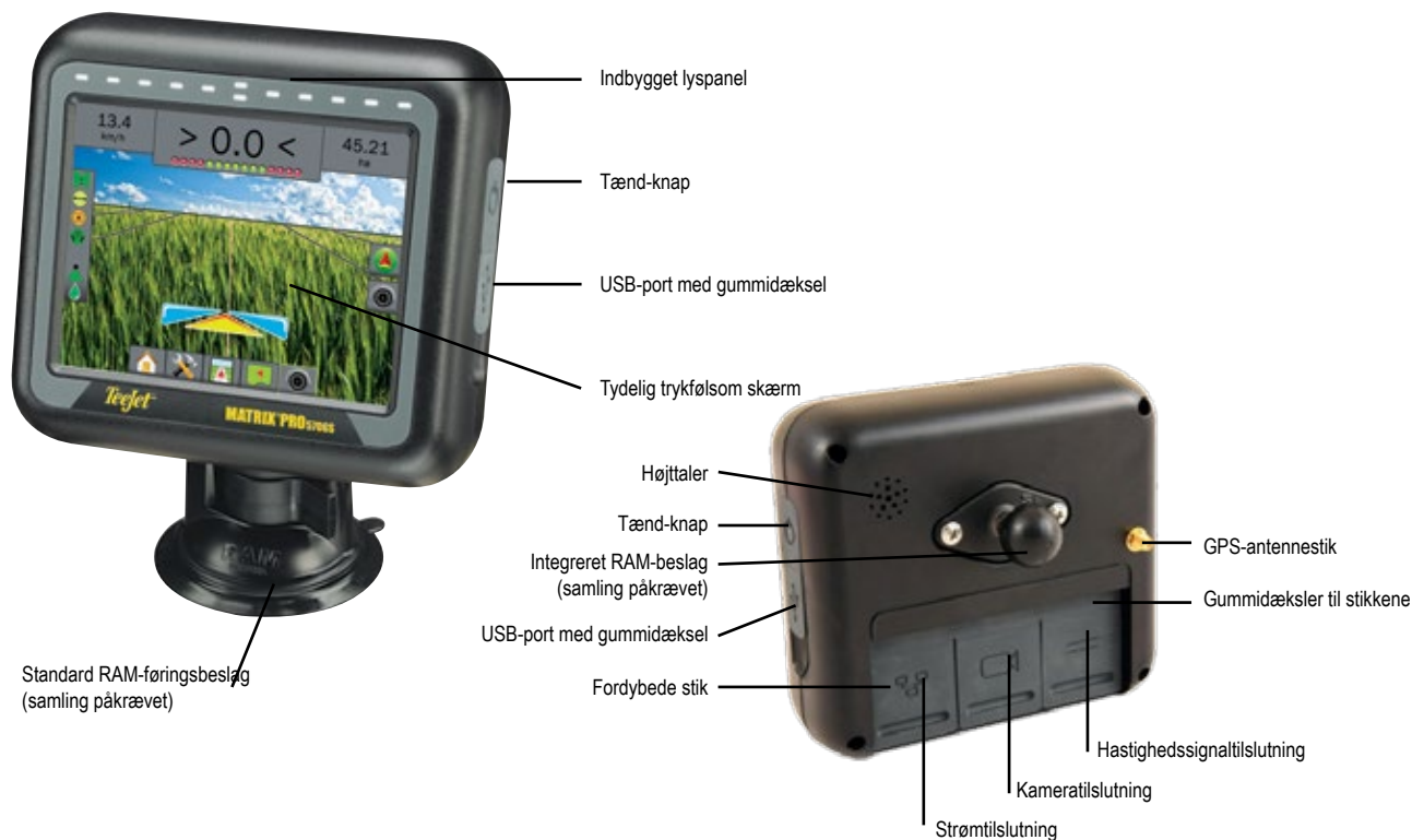
Figur 1-1: Matrix Pro 570GS-konsol – for- og bagside
