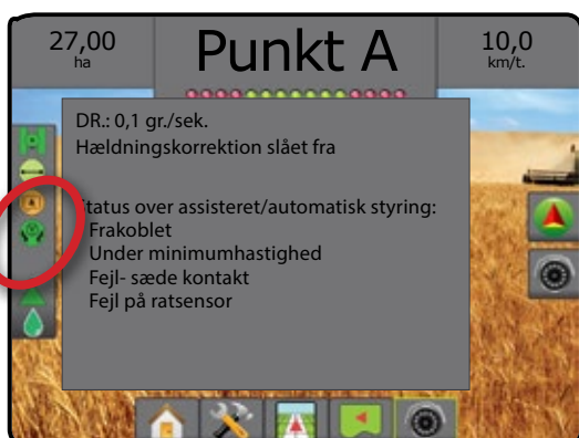
Figur 6-7: Status Assisteret/automatisk styring
