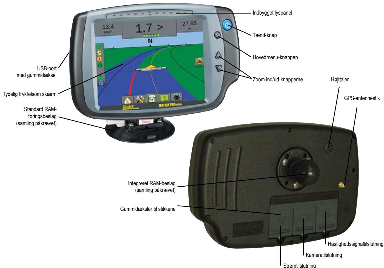
Figur 1-2: Matrix Pro 840GS-konsol – for- og bagside
