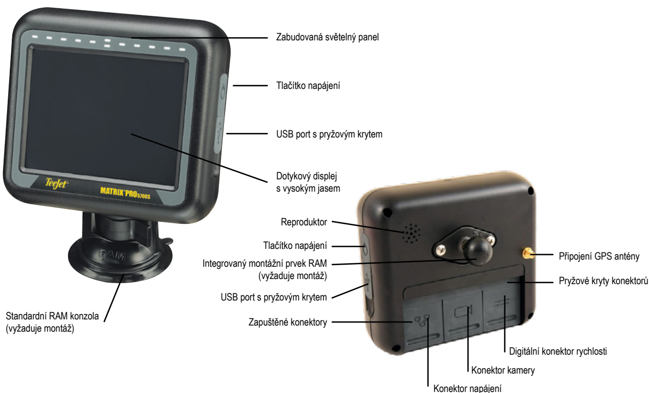
Obr. 1-1: Přední a zadní strana konzoly Matrix Pro 570GS
