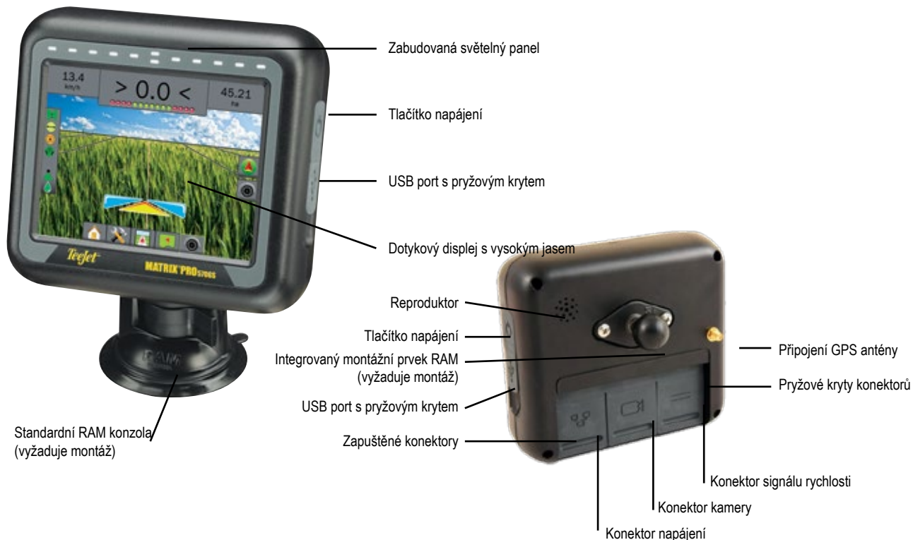
Obrázek 1-1: Přední a zadní strana konzoly Matrix Pro 570GS
