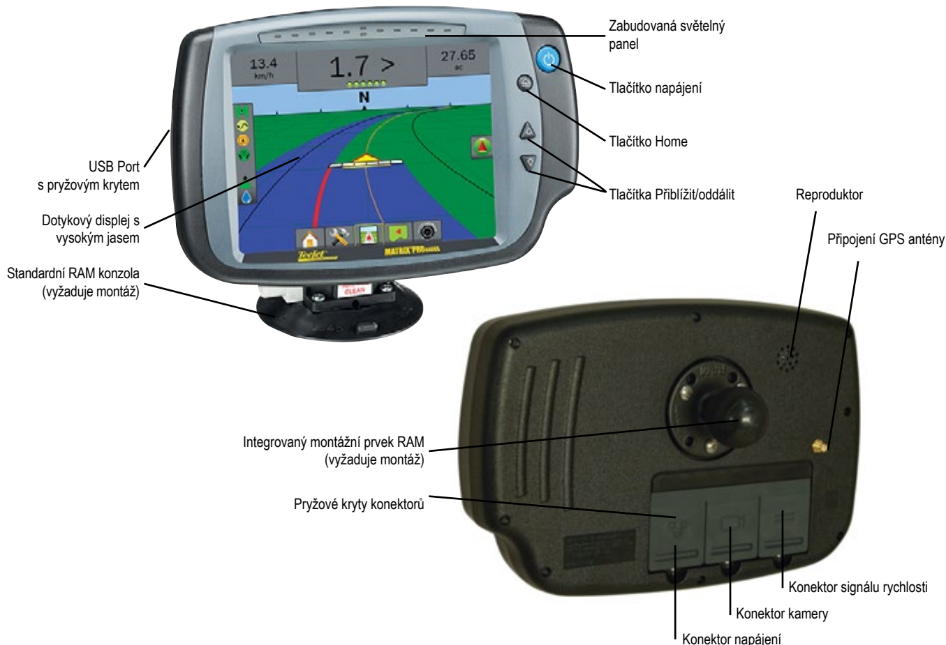
Obrázek 1-2: Přední a zadní strana konzoly Matrix Pro 840GS
