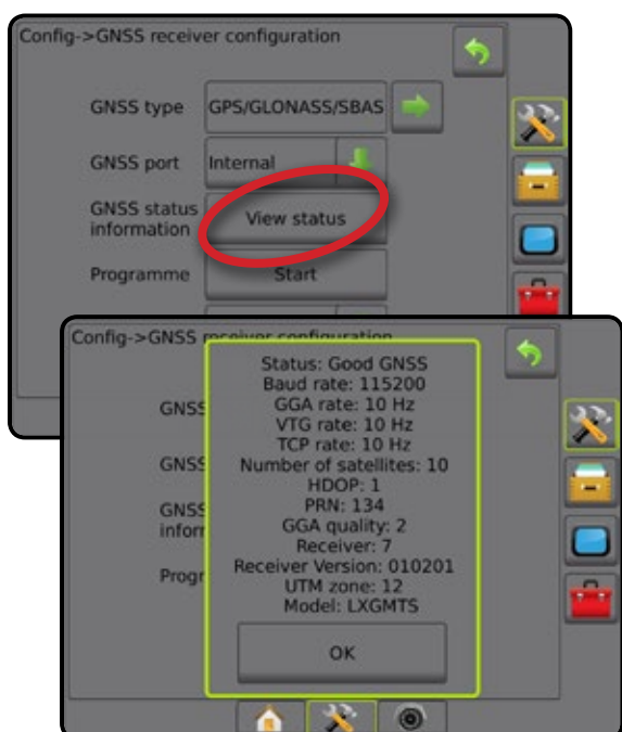
Obr. 5-4: Informace o stavu GNSS
