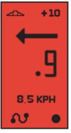
**Der Kontur-A-B-Modus** bietet kurvige Führung zwischen zwei Bezugspunkten A/B (eine detailliertere Beschreibung finden Sie auf Seite 5). Alle Spuren sind mit der beim ersten Durchlauf zwischen den ursprünglichen Punkten A & B gefahrenen Strecke identisch.
