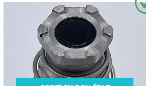
JOINT EN BON ÉTAT
