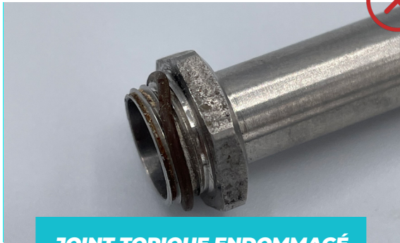
JOINT TORIQUE ENDOMMAGÉ
