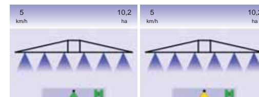
4-16 ábra: Automata állásból Minden Szakasz Bekapcsolva üzemmódba
