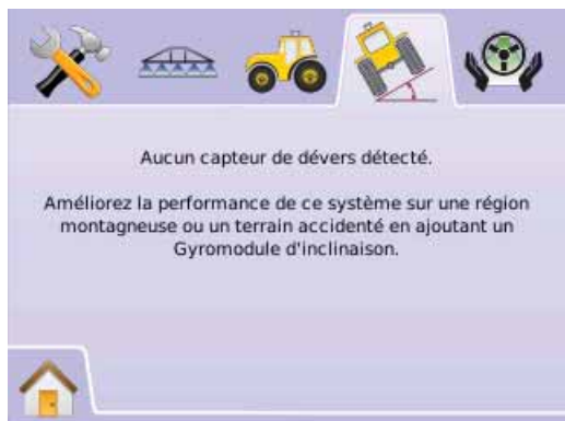
Illustration 2-53: Module de gyro-dévers non détecté
