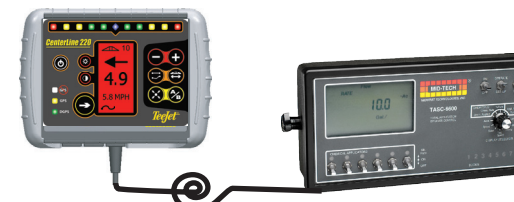
Calibrage du signal de vitesse radar # pour contrôleur MID-TECH : 1000
